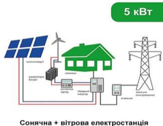
Рис. 3. Схема сонячної та вітрової електростанції у домогосподарстві
